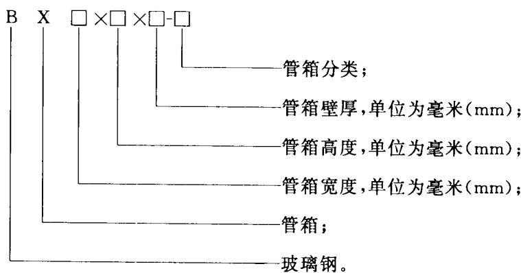
示例：长 2 000 mm, 宽 370 mm, 高 240 mm, 壁厚 5 mm 的接头玻璃钢管箱标记为：BX370×240×5-II。
