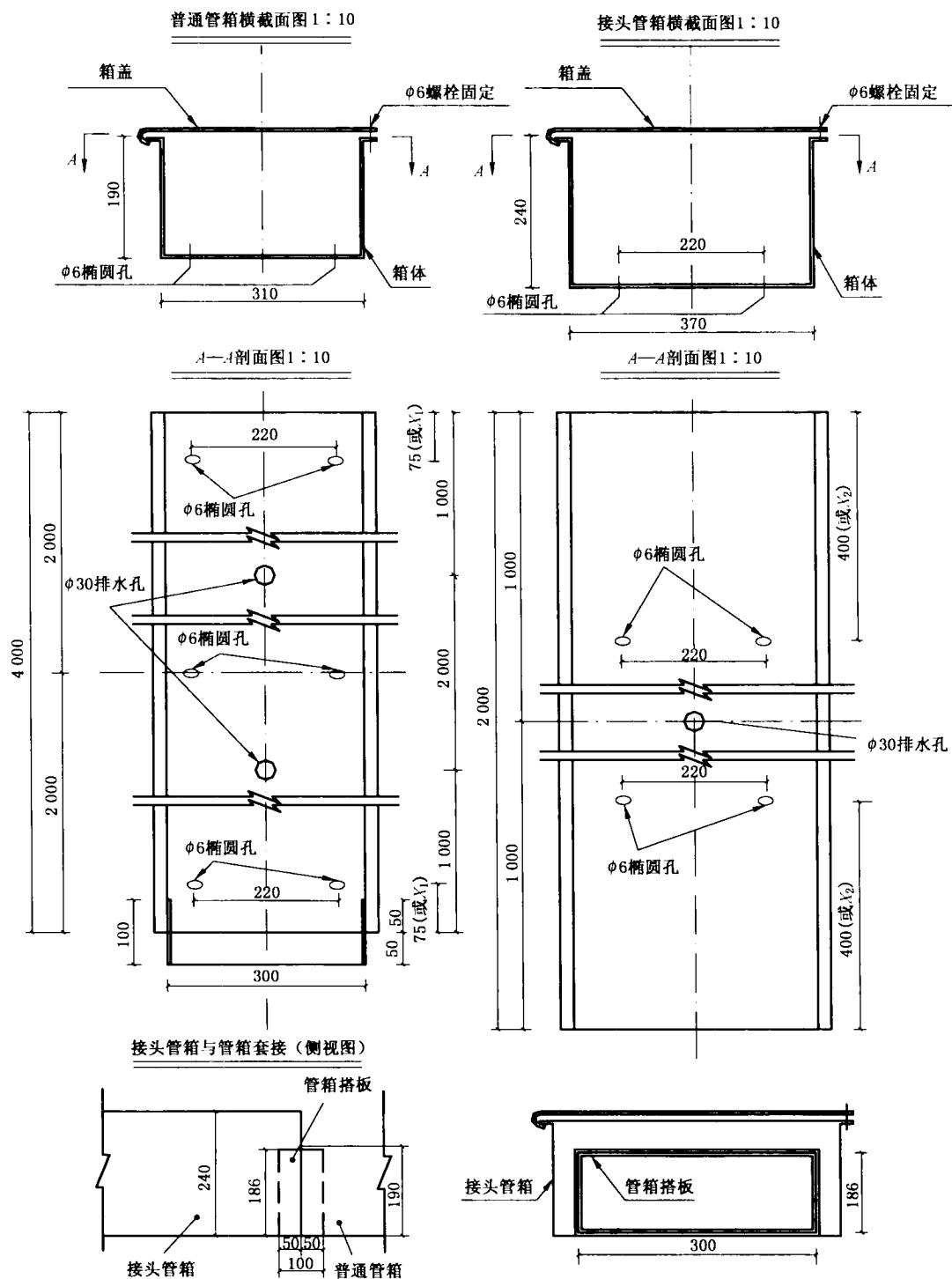
本图为管箱结构示意图,其他规格和 $X_1$ 、 $X_2$ 等具体结构值由工程设计图纸决定。
