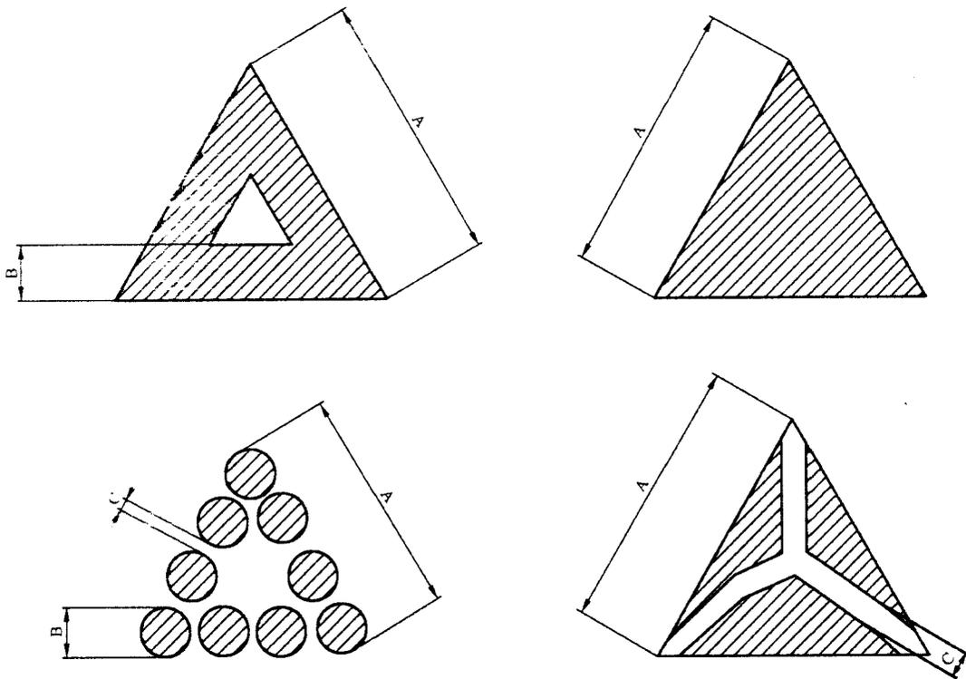
图 1 Ⅲ A 和 Ⅲ B 类反射器发光区域外形示意图
